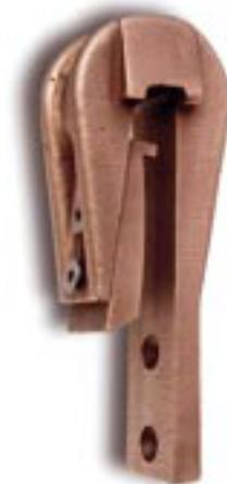
Der **ERKO**<sup>®</sup>-Kontaktkopf wird von oben nach unten auf die Waren- bzw. Kathodenschiene geschoben. Eine Spannplatte preßt die Kontaktfläche des Kopfes über die Keilwirkung der Gleitbahnführung gegen die Warenschiene, und stellt so die kraftschlüssige Kontaktierung her. Mit einem Handhebel, der zwischen die Warenschiene und eine am Kontaktkopfvorgesehene Nase geschoben wird, oder nur durch Gegendruck, läßt sich die Verkeilung leicht lösen.
